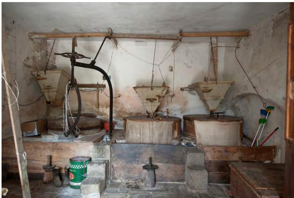
Tramogge del grano e alloggiamento delle macine mosse della ruota idraulica sottostante.
